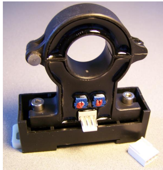
Sensor mit MOLEX-Verbinder (Der Abstand zwischen Boden und Mitte des Loches beträgt 54.8mm)
