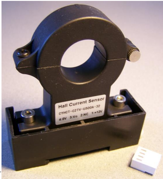
Sensor mit MOLEX-Verbinder (Der Abstand zwischen Boden und Mitte des Loches beträgt 54.8mm)
