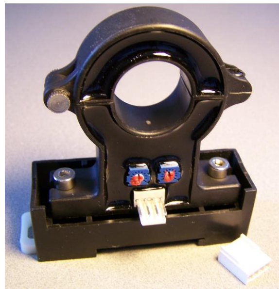
Sensor mit Molex Verbindung (Der Abstand zwischen Boden und dem Lochmittelpunkt beträgt 54.8mm)
